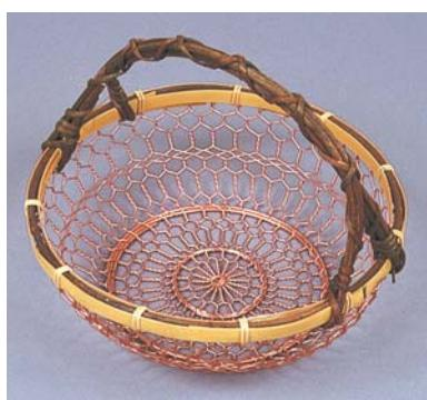
金網細工に使用する道具は、釘を打ちつけた台だけである。その釘に合わせて針金を編んでゆく。何度も針金をねじることができ、枠の中で好みの編み目を出せるのが手編みの持味であり、張り替えがきくのも大きな長所である。昔ながらの台所用品のほか、近年では料理の器や小道具などに用途が広がってきてている。
