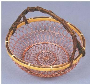
金網細工に使用する道具は、釘を打ちつけた台だけである。その釘に合わせて針金を編んでゆく。何度も針金をねじることができ、枠の中で好みの編み目を出せるのが手編みの持味であり、張り替えがきくのも大きな長所である。昔ながらの台所用品のほか、近年では料理の器や小道具などに用途が広がってきていている。
